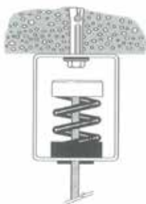
Montage avec contact direct
